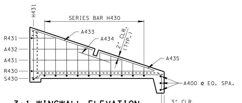
3:1 WINGWALL ELEVATION NOTE: A-BARS IN HEADWALL NOT SHOWN FOR CLARITY.
